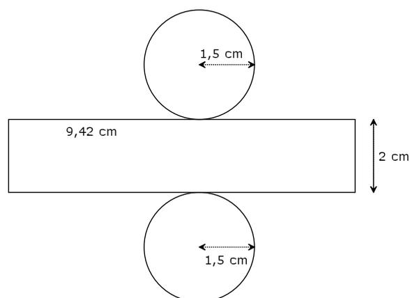
Si un cylindre droit a pour rayon 1,5 cm et pour hauteur 2 cm, les dimensions du rectangle de son patron sont : 2 cm et  $2 \times 3,14 \times 1,5 \approx 9,42\ \text{cm}$ .
