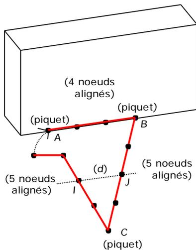
Pour tracer sur le sol une droite parallèle au bord du mur (que représente le parallélépipède) avec une corde à 12 nœuds (les distances entre deux nœuds consécutifs étant toutes égales) :
