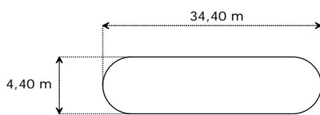
Ci-contre le schéma d'un réservoir constitué d'un cylindre et de deux demi-sphères.
